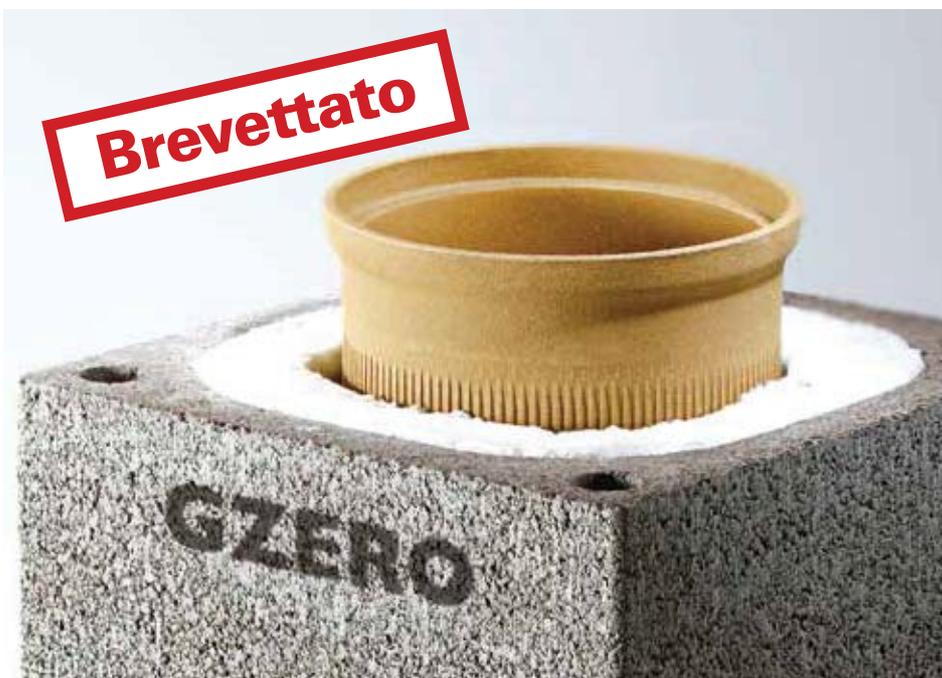
**Schiedel GZERO** è realizzato internamente da refrattario ceramico ultra sottile resistente ad altissime temperature, rivestito da un elemento in cls alleggerito vibro compresso pre-isolato con fibra ceramica ad alta densità ed elevato spessore, dotato di condotto di ventilazione opzionale studiato per l'adduzione dell'aria comburente.
